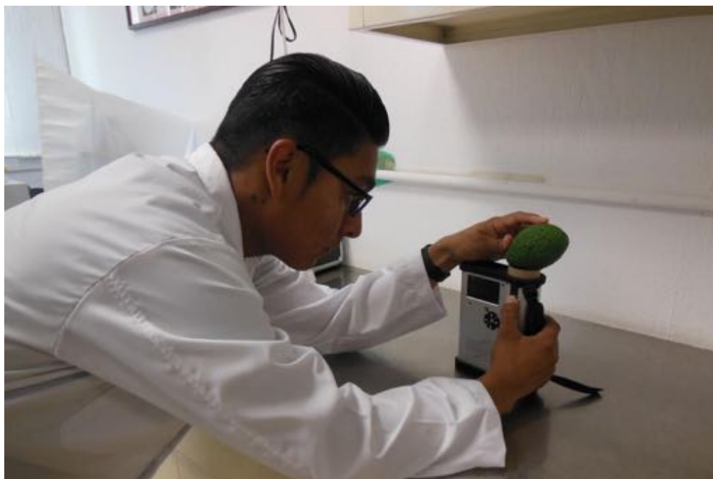
Figura 2. Escaneo de frutos de aguacate 'Hass' mediante espectrómetro F-750.
