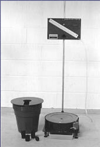
El Lisímetro de Armfield consta de tres recipientes de 300mm de diámetro en los cuales se coloca suelo de cualquier tipo y se cultiva una variedad de cultivos. Cada recipiente a su vez se coloca sobre una placa montada hidráulicamente que se utiliza para monitorizar cambios en el peso del sistema debidos a la evapotranspiración.
